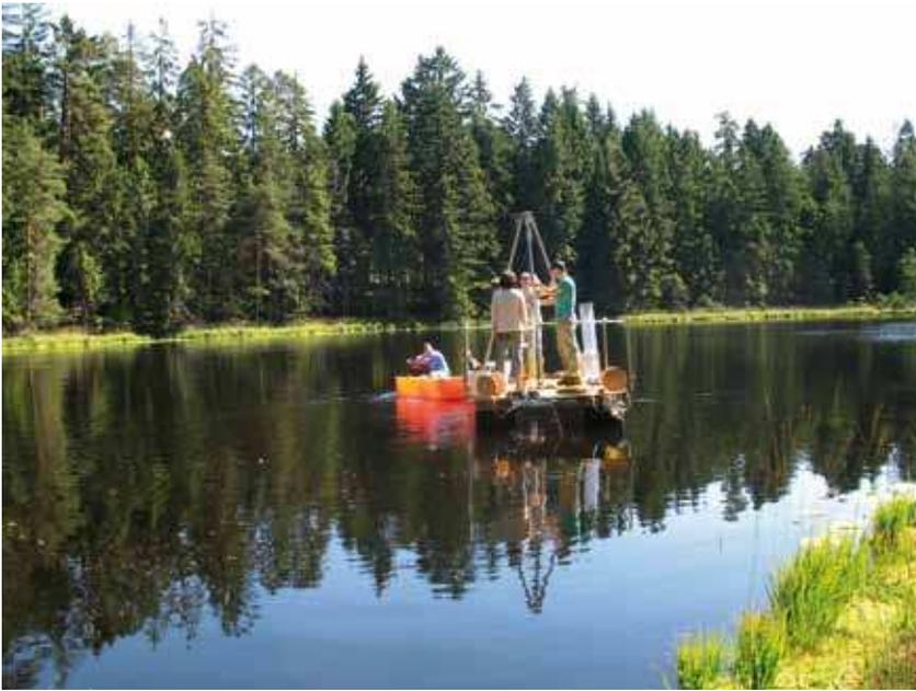
Abb. 3: Die Kurzkerne wurden von einem Floß aus mit einem Niederreiter-Bohrgerät entnommen.
